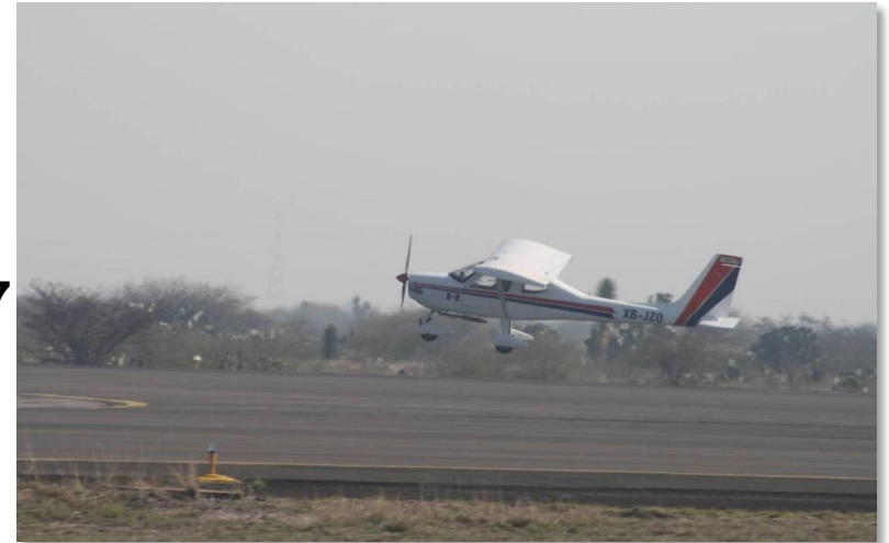
Tree blades, R1100S BMW power plant, Aeromarmi SA de CV®
