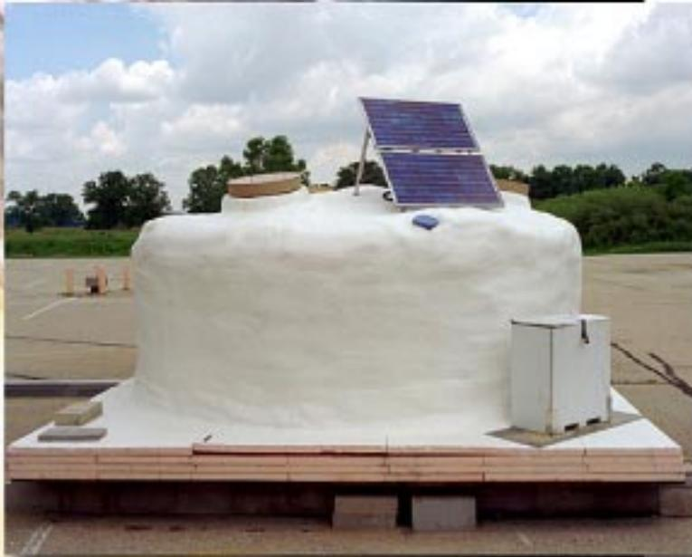
*Prototipo del detector de superficie del Observatorio Pierre Auger.*
