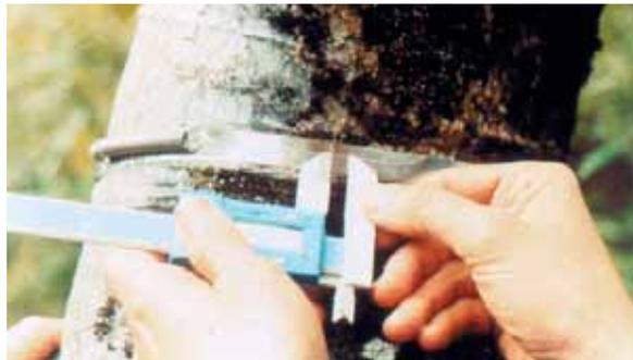
Figura 2. Árbol de *Bursera glabrifolia* con dendrómetro, al que se mide el incremento con un vernier.
