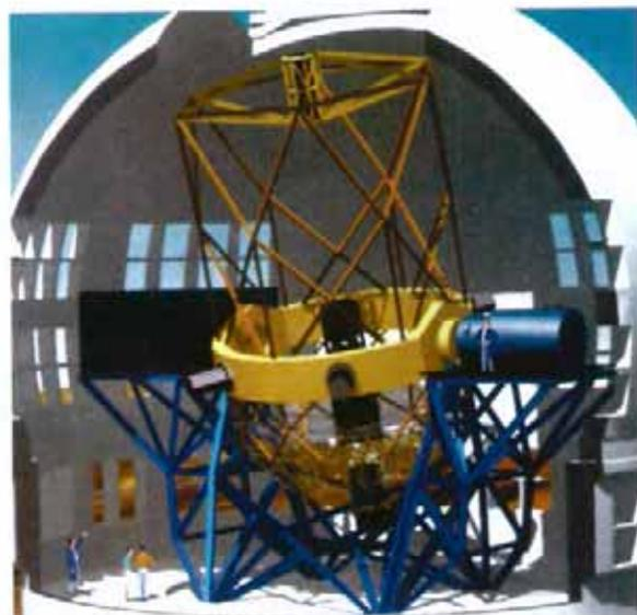
como telescopio robótico y tiene una cúpula que se abre completamente. Cuando esto sucede, el telescopio se mantiene a la temperatura exterior, así se evitan los problemas de turbulencia que dificultan las observaciones.
