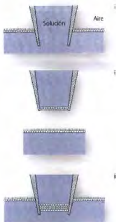
Figura 4. Formación de una bicapa a partir de monocapas preformadas en la punta de una pipeta de patch-clamp: (i) se forma una monocapa alrededor de la punta de una pipeta previamente sumergida, (ii) se jala la pipeta permitiendo así la formación de una monocapa en la punta de la misma y (iii) se sumerge nuevamente la punta de la pipeta, formándose así la bicapa artificial.
