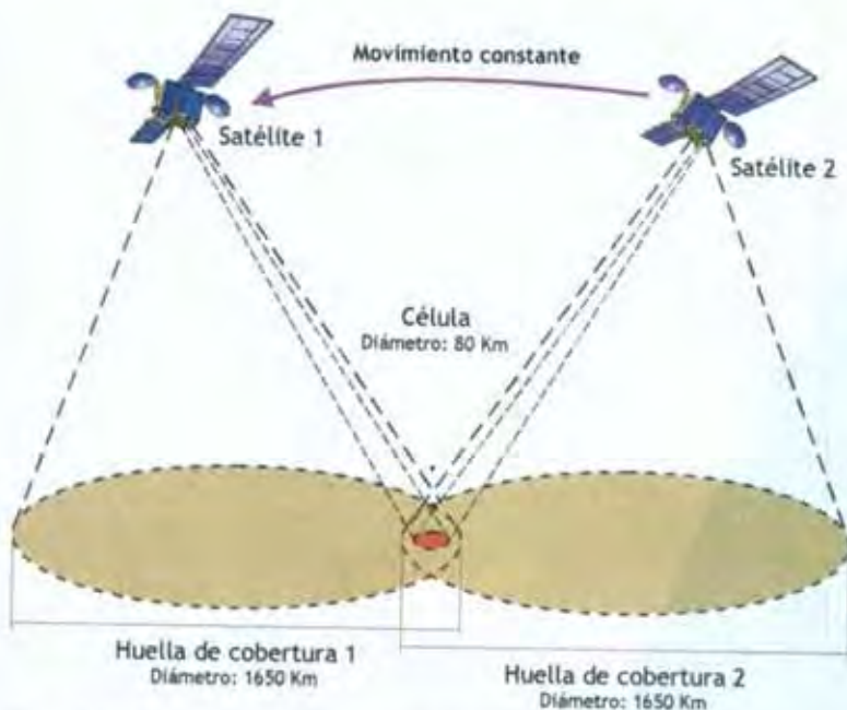
Figura 3. Huellas de dos satélites adyacentes y muestra de una célula de cobertura de la constelación satelital Teledesic. Cada huella de cobertura tiene 1 650 Km de diámetro y está dividida en muchas células cuyo diámetro es de sólo 80 Km. Esta división se realiza mediante el uso de haces puntuales dirigidos electrónicamente de acuerdo con el movimiento del satélite, dependiendo de la distribución y las necesidades de las terminales a las que se les dará servicio. Las células son móviles conforme los satélites se desplazan en sus planos orbitales y la comunicación nunca se interrumpe al transferirse las señales de un satélite a otro por medio de enlaces intersatelitales (véase la fig. 4).
