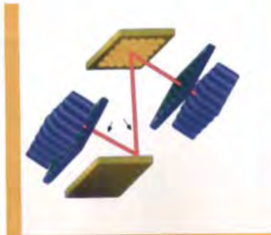
Banco conmutador óptico experimental de 256 microespejos.
