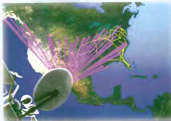
Figura 8. Ejemplo de los haces puntuales del sistema satelital global Spaceway, para su cobertura en Norteamérica. El sistema empleará procesadores digitales a bordo y tecnología de haces puntuales con conmutación de paquetes, para ofrecer comunicaciones punto a punto ( http://www.hns.com/products/advanced_platforms/spaceway/inside_spaceway.htm ). Nótese la similitud de cobertura con la del satélite regional Anik F2 de la figura 1.
