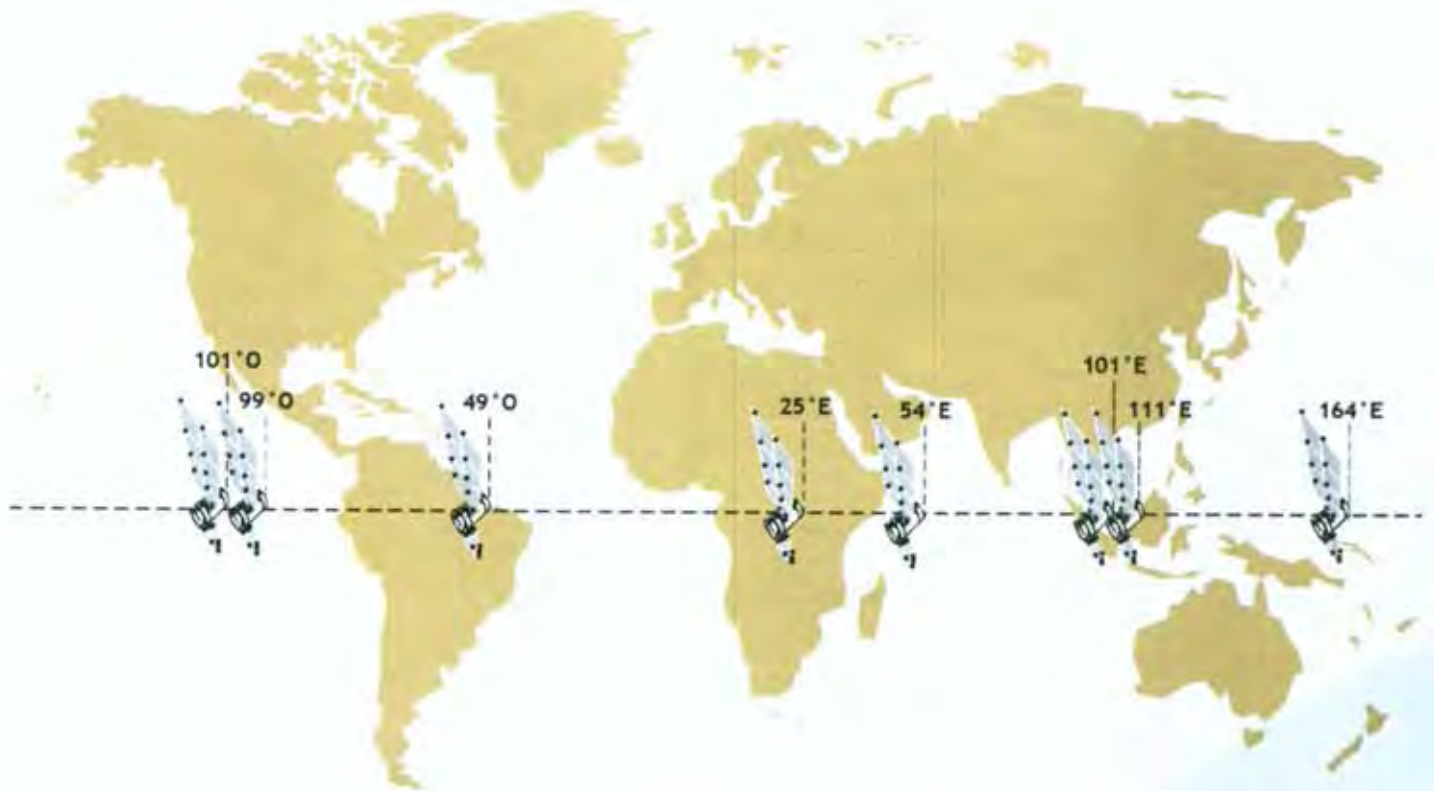
Figura 7. Posición orbital de los satélites geoestacionarios del sistema global Spaceway en su etapa inicial de cobertura.
