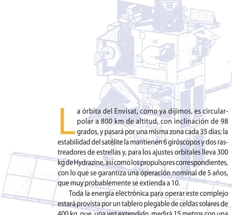
**L**a órbita del Envisat, como ya dijimos, es circular-polar a 800 km de altitud, con inclinación de 98 grados, y pasará por una misma zona cada 35 días; la estabilidad del satélite la mantienen 6 giróscopos y dos rastreadores de estrellas y, para los ajustes orbitales lleva 300 kg de Hydrazine, así como los propulsores correspondientes, con lo que se garantiza una operación nominal de 5 años, que muy probablemente se extienda a 10.
