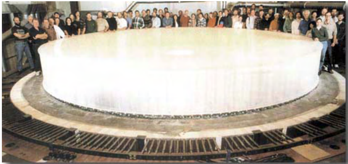
Espejo número 1 del telescopio LBT, todavía sobre el horno giratorio, donde se fundió en 1999. Este espejo ya se encuentra instalado en el telescopio; y el espejo 2 está ya en proceso de pulido.
