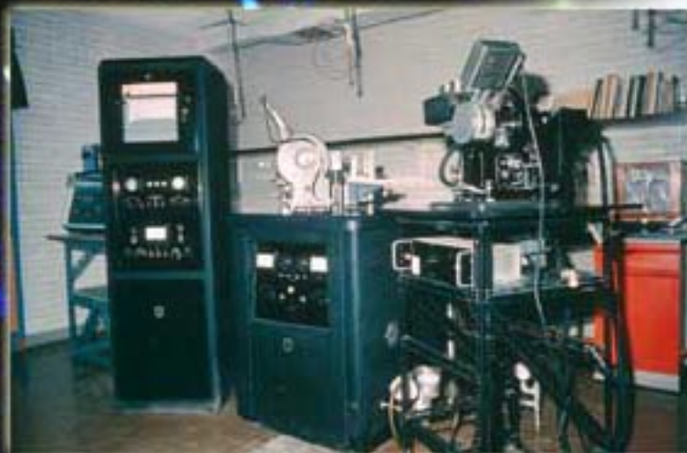
Figura 10. Espectrodifractómetro de rayos X marca Philips, instalado en el Laboratorio de Rayos X del Instituto de Física en 1954. Fotografía proveniente del Archivo del Laboratorio de Rayos X del IFUNAM.
