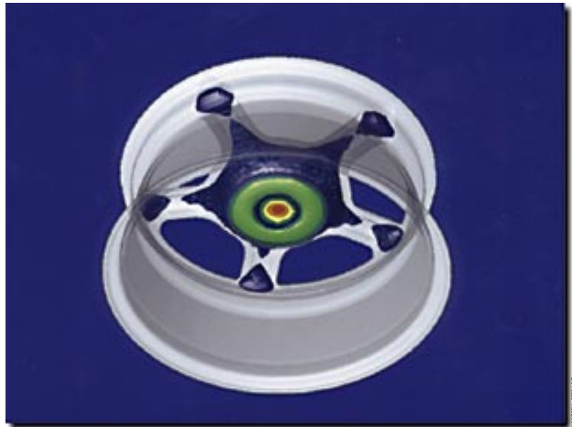
Modelo elaborado por PAM-CAST, nuevo software de simulación para el moldeo de piezas metálicas.
