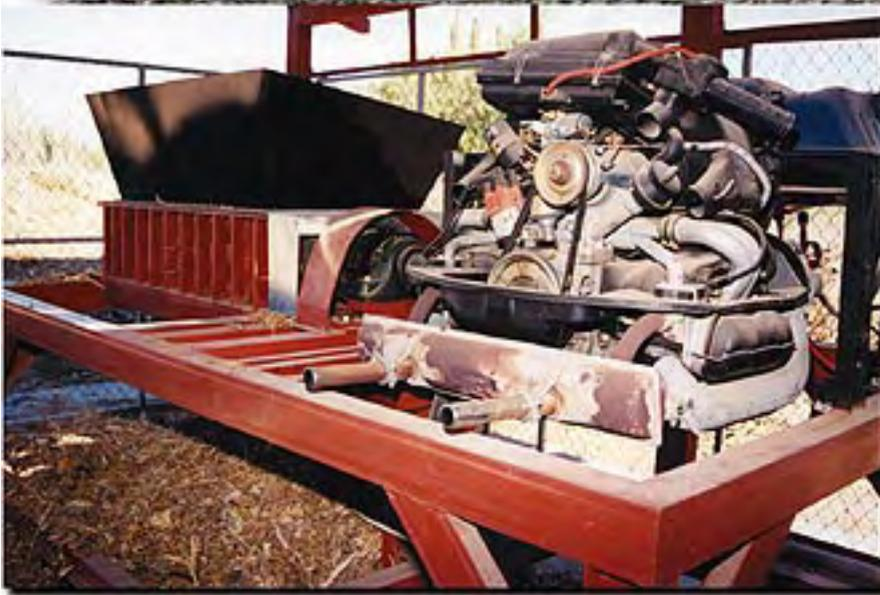
*Trituradora mecanizada de residuos vegetales, diseñada en el CIB y utilizada para elaborar compostas.*
