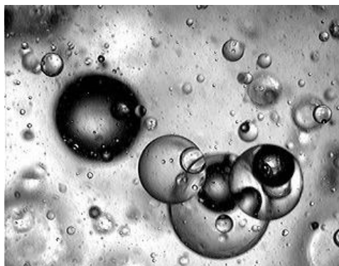
Interior de un fermentador agitado. Gotas de aceite (semitransparentes) y burbujas de aire (oscuras); imagen a la izquierda. Gotas multifásicas: gotas de aceite (semitransparentes) que contienen en su interior burbujas de aire (oscuras) y microgotas de la fase acuosa; imagen a la derecha. Estas fotografías son cortesía de los doctores Enrique Galindo y Gabriel Corkidi, del Instituto de Biotecnología de la UNAM.
