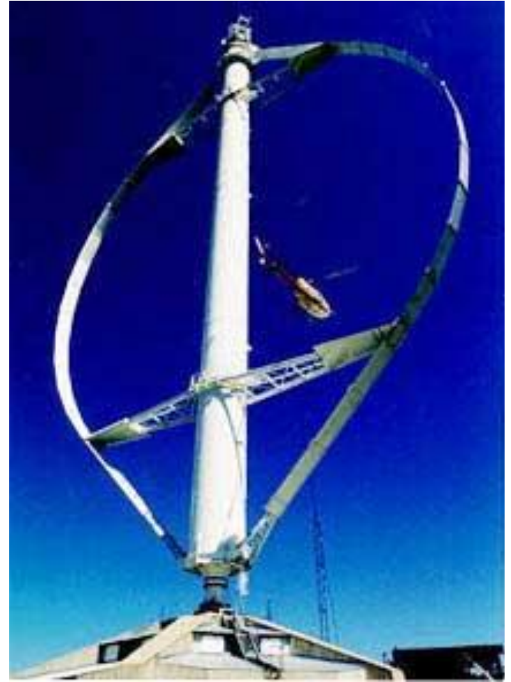
La "eóle" en Canadá de 4MW. Hasta hace poco la aeroturbina más grande del mundo. Opera ahora con una potencia reducida de 2.5MW.
